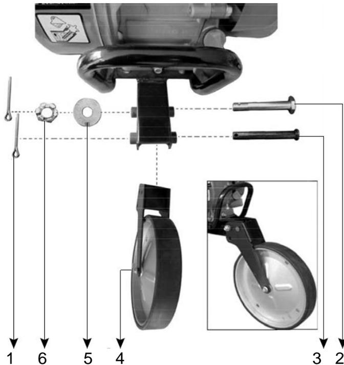
Установите скобу переднего колеса **4** на раму устройства так, чтобы совпали оба отверстия на скобе с отверстиями на раме. Затем в отверстие ближе к двигателю вставьте болт **2** и закрепите его шайбой **5** и гайкой **6**. Во второе отверстие вставьте палец **3**. Болт **2** является поворотной осью, в то время как палец **3** может фиксировать переднее колесо в 2х положениях: для транспортировки и для культивации.
