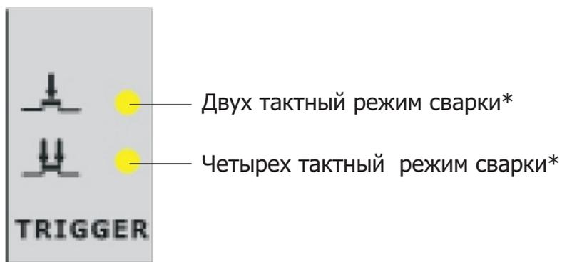
\* Двухтактный режим применяется на коротких швах, четырехтактный режим целесообразно применять на длинных швах для удобства сварочного процесса.
