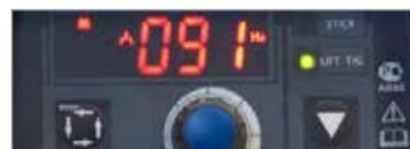
**1 шаг:** Настройка частоты пульса. Диапазон от 0 до 100 Гц. При установке «0», режим пульс выключается.
