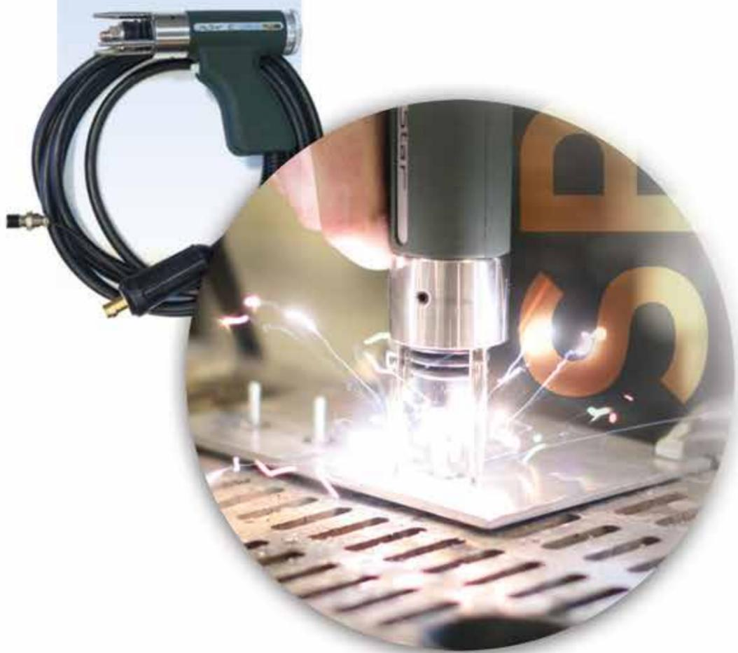
Конденсаторная сварка – разновидность контактной сварки (SPOT), при котором для нагрева соединяемых изделий используют кратковременный мощный импульс тока (запасённая энергия), получаемый от батарей статических конденсаторов.
