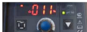
**3 шаг:** Настройка второго тока импульса. Диапазон от 10 до 50%. Настраивается уровень сварочного тока импульса в отношении к основному, пиковому току.
